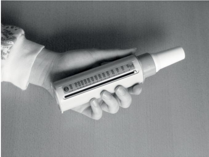
Das Demonstrationsmundstück ist nur für Sie gedacht, nicht für die Zielperson. Nutzen Sie dieses Mundstück aus Kunststoff für die Demonstration der Lungenfunktionsmessung. Nehmen Sie anschließend das Demonstrationsmundstück wieder ab und desinfizieren Sie die Ansatzstelle
